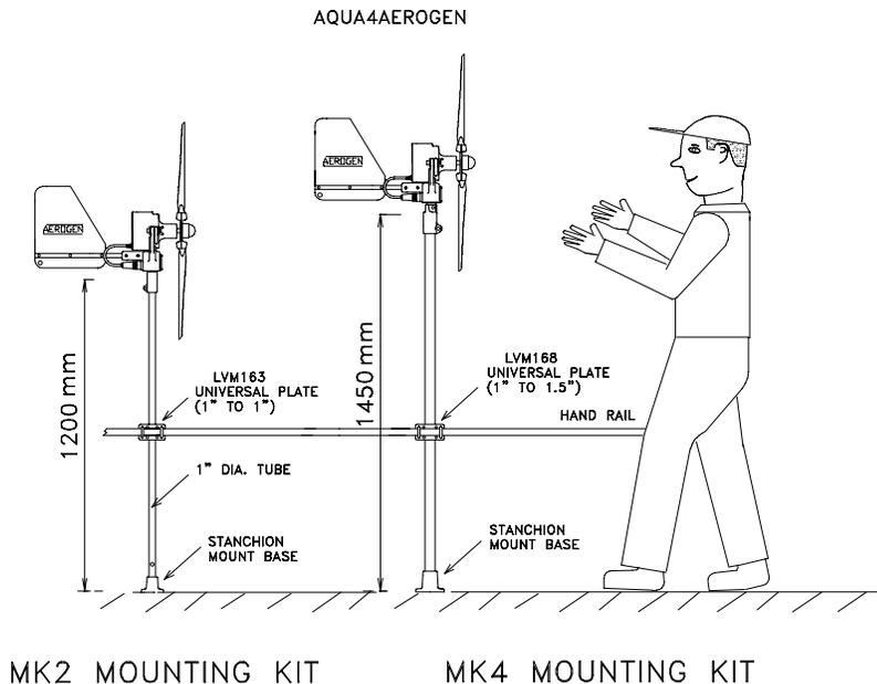
NOTE : THE AQUA4AEROGEN MUST BE FITTED WITH A 1.5 inch ADAPTOR.
